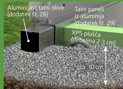
S **talnim okvirjem iz aluminija**, hiško lahko postavite in zasidrate tudi na gramozno podlago (talna sidra so na voljo kot dodatna oprema). **Talni paneli iz aluminija** služijo kot funkcionalna tla in so podloženi s ploščami iz trdne pene XPS (plošče iz trde pene XPS niso vključene v dostavo).
