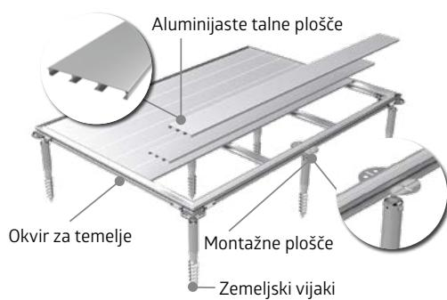
**Čas montaže:** 2 - 4 uri za dva (odvisno od spretnosti in izdelka). **Potrebno orodje:** udarni vrtalnik, sveder Ø 40 x 570 mm, vodna tehtnica, vrtalnik, viličasti ključ 13 in 24, lopata.
